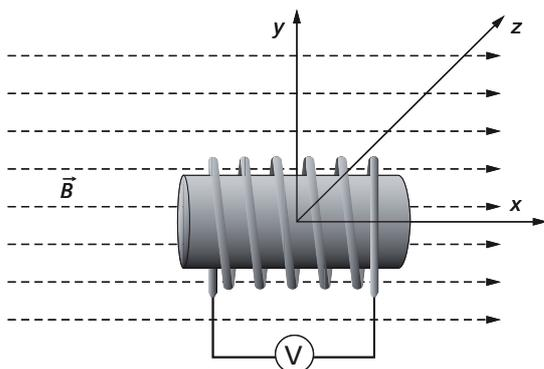
4. In einer Spule wird eine Spannung induziert, wenn sich das von der Spule umfasste Magnetfeld ändert. Die Ursache dafür kann entweder eine Änderung der wirksamen Spulenfläche oder ein zeitlich veränderliches Magnetfeld sein.
