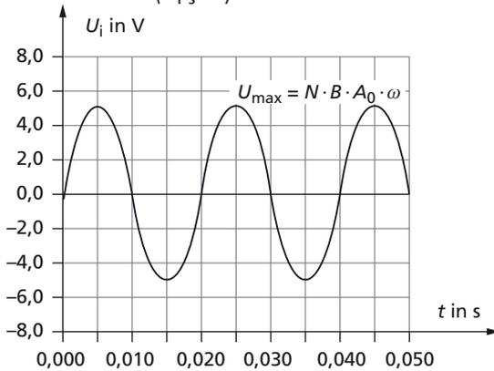
18. a) Unter einer glaskeramischen Platte sind Spulen verschiedener Induktivität installiert. Beim Fließen eines Wechselstromes wird um diese Spulen ein magnetisches Feld aufgebaut. Das Feld durchdringt die Keramikochfläche. Werden Metallgegenstände in das Kochfeld gebracht, induzieren die magnetischen Felder Wirbelströme, die das Material stark erhitzen.
